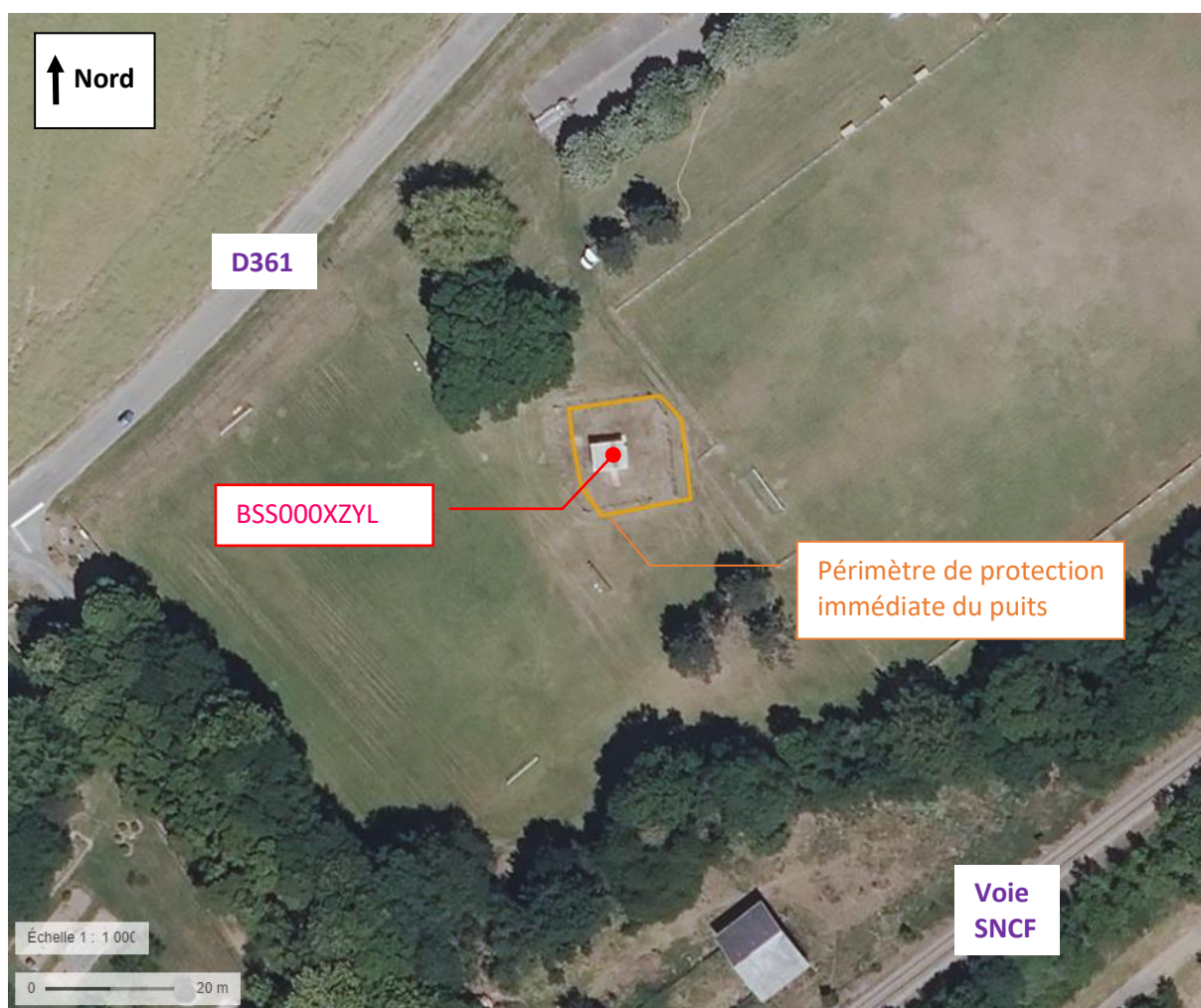
Figure 5 : Périmètre de protection immédiate du captage
